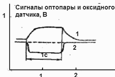
Рис. 4.16. Динамические характеристики оксидного датчика, исследованные с помощью экспериментальной установки:
