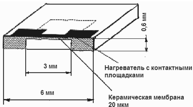
Рис. 3.9. Конструкция микромашиного чипа, изготовленного с использованием мембраны из оксида алюминия
