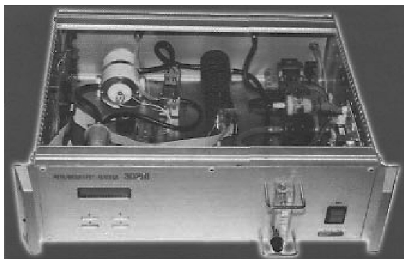
Рис. 1.7. Внутреннее строение газоанализатора для атмосферного мониторинга
